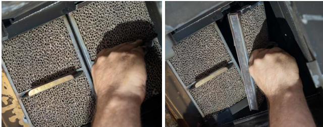
Entfernen der Katalysatoreinheiten bei Panorama-Formaten
